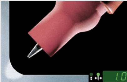
Tungsten uç çapı: 1 mm Temel işlem maddesi: AlMg3 Malzeme kalınlığı: 5 mm Kaynak akımı: 185 A Kaynak gerilimi: 15,6 V AC Balans: -5
