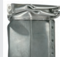
/ Çelik ve alüminyumun hibrit bağlantısı / Darbe testi onaylı
